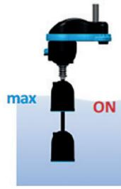
Les flotteurs ferment le contact magnétique. La pompe est actionnée et la cuve se vide.
