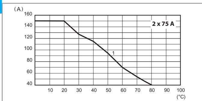
1 - Installation avec dissipateur thermique (0.45 K/W)
