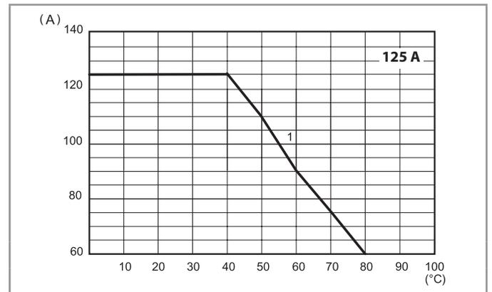
1 - Installation avec dissipateur thermique (0.35 K/W)
