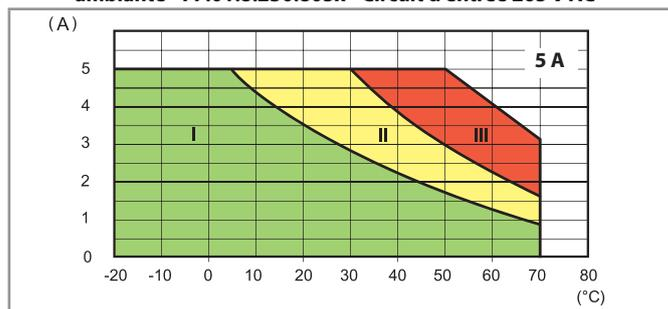
**L77-3 Courant efficace maximum DC en fonction de la température ambiante - 77.01.9.024.9024 - Circuit d'entrée 32 V DC**
