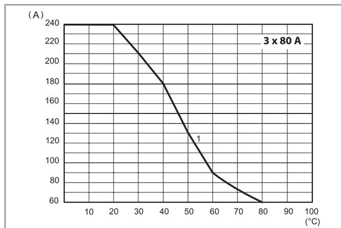
1 - Installation avec dissipateur thermique (0.35 K/W)
