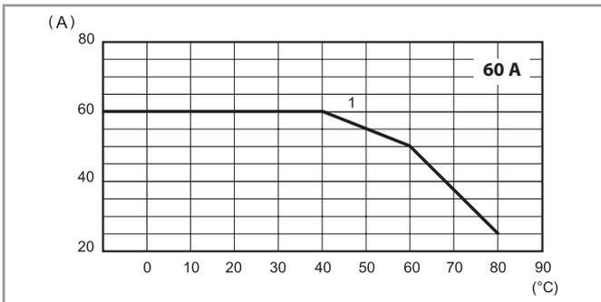
1 - Installation avec dissipateur thermique (0.7 K/W)
