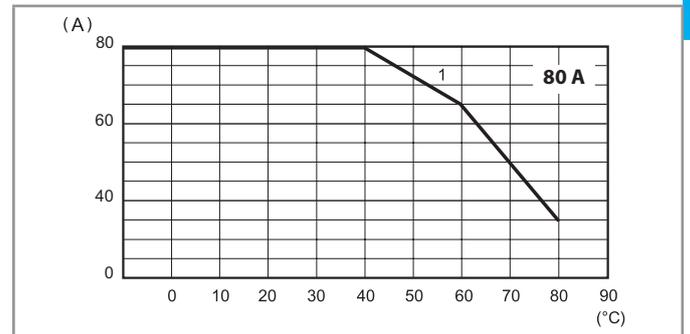
1 - Installation avec dissipateur thermique (0.5 K/W)
