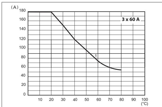
1 - Installation avec dissipateur thermique (0.45 K/W)
