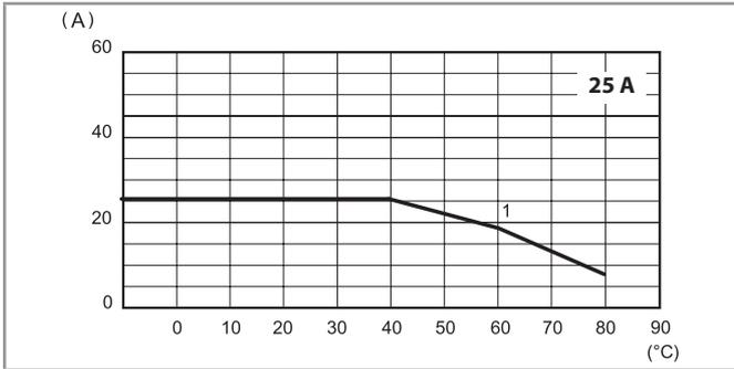
1 - Installation avec dissipateur thermique (2 K/W)
