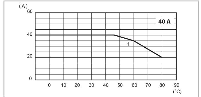
1 - Installation avec dissipateur thermique (0.9 K/W)
