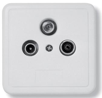
Série de prises rondes à 2, 3 ou 4 sorties avec connecteur IEC femelle pour la bande radio, IEC mâle pour la bande TV et connecteur F femelle pour la bande Satellite.
