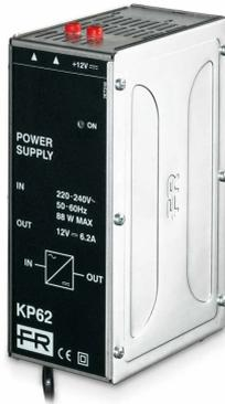
Construit avec une technologie de commutation pour garantir une efficacité et une fiabilité élevées, protégé contre les surcharges temporaires et prolongées. Classe d'isolation : II. Température de fonctionnement : -10°C à +55°C.
