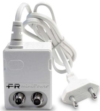
Alimentation miniature à découpage 12V stabilisée à haut rendement et à faible consommation avec 1 entrée, 1 sortie et un courant de sortie de 200mA. **Prise de type C** pour le raccordement au réseau.
