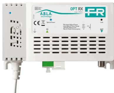
**Récepteur optique OPT-MBJ** avec une sortie RF large bande pour la réception de signaux TV+SAT distribués sur une seule fibre. Plage d'entrée optique de **0 à -15dBm** ; fenêtre de fonctionnement optique 1270-1610nm. (dimensions 135x82x39mm)
