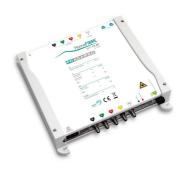
Transmetteur optique pour la distribution de jusqu'à 4 satellites sur une seule fibre en utilisant la technologie CWDM (Coarse Wavelength Division Multiplexing). Solution innovante pour transmettre toute la bande TV, y compris les signaux radio, et toute une position orbitale sur une seule fibre. 7dBm avec le laser FP SAT+TV+FM, longueur d'onde 1310nm. (dimensions 230x230x50mm)
