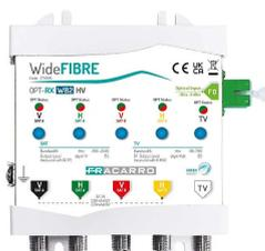
**Récepteur Wide Fibre** qui convertit le signal optique provenant de l'émetteur **OPT-TX WB2** en coaxial; il dispose de **5 sorties: 4 polarités satellite large bande** (V SatA, H SatA, V SatB et H SatB) **et le signal TV**.
