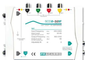
Unité de contrôle IF-IF compacte pour convertir jusqu'à 32 transpondeurs DVB-S/S2 avec la technologie SCD2 (dCSS) ; 4 entrées satellites et 2 dérivés avec un niveau de sortie de 86dB $\mu$ V par transpondeur.
