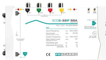
Unité de contrôle IF-IF compacte pour convertir jusqu'à 32 transpondeurs DVB-S/S2 avec la technologie SCD2 (dCSS) ; 4 entrées satellite, 1 entrée TV passive et 1 dérivée mixte avec un niveau de sortie satellite total de 127dBuV; réglage du gain satellite de 20dB et réglage de la pente satellite de 15dB.
