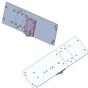
**Support modulaire de barre DIN 26,5 cm** pour installer les produits à l'intérieur du QDSA ou dans les barres DIN à l'intérieur des racks.
