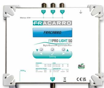
Stations programmable à 3 entrées (VHF+DAB / UHF flexible) pour un filtrage à haute sélectivité avec un niveau de sortie jusqu'à 108dBμV pour chaque filtre. 32 filtres de 1 à 6 canaux, chacun avec 9 niveaux de sélectivité.
