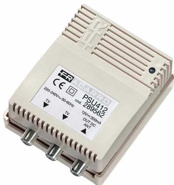
Alimentation à découpage stabilisée 12V à haut rendement et à faible consommation avec 1 entrée, 2 sorties et un courant de sortie de 200mA. Prise de type C pour le raccordement au réseau.
