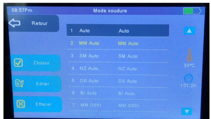
Pour créer un nouveau mode, défilez jusqu'au dernier mode mémorisé et sélectionnez Add new, après l'avoir sélectionné il me propose d'utiliser l'un des modèles présents.
