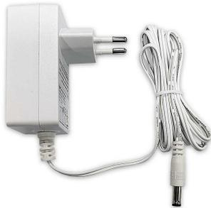
Alimentation 12V 1.5A sur **connecteur mâle** (2.1x5.5x12 ; intérieur positif, extérieur négatif) et prise européenne.
