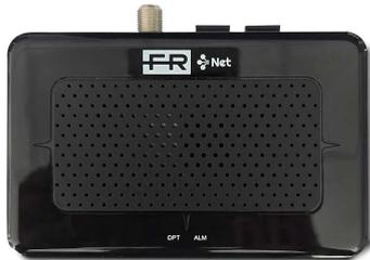
Terminal de réseau optique actif pour la distribution de signaux de télévision numérique via le réseau PON. Le récepteur est équipé d'un diplexeur WDM intégré pour séparer la bande TV des datas.
