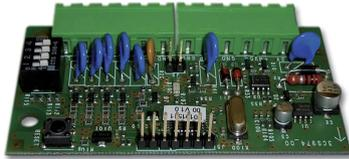
Cartes d'extension à 4 entrées (M4IBUS) ou à 8 entrées (M8IBUS) qui permettent d'augmenter le nombre de zones dans les centrales filaires du système Defender. Grâce à la connexion BUS RS485, il est possible de délocaliser ces modules à l'intérieur du système ou de créer des points de concentration sans devoir amener toutes les zones à l'unité de contrôle
