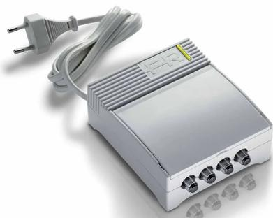
Amplificateur pour intérieur avec 1 entrée (VHF + UHF) autoalimenté avec voie de retour et 2 sorties, gain de 20 dB et niveau de sortie jusqu'à **108dB $\mu$ V** dans la bande UHF, réglage du niveau (15dB) et faible facteur de bruit.
