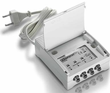
Amplificateur pour intérieur avec 3 entrées (FM, III+DAB, UHF) autoalimenté avec un gain de 30dB et niveau de sortie jusqu'à 110dB $\mu$ V en bande UHF, réglage du gain (15dB) indépendant pour chaque entrée et faible facteur de bruit.
