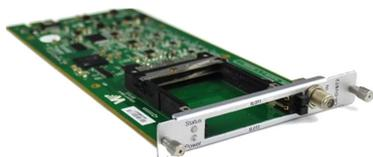
Le **GX-4T2CI-BP-00** est un récepteur numérique terrestre équipé d'un connecteur d'entrée coaxial RF (F femelle) et de deux emplacements pour interface commune PCMCIA. Le module est capable de syntoniser jusqu'à **quatre multiplex terrestres numériques DVB-T/T2**, de décrypter les programmes codés via les CAM et les cartes, et de partager le contenu via le panneau arrière du châssis **GALAXIA**.
