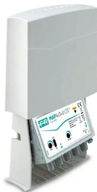
Amplificateur sur mât à 4 entrées (FM, III+DAB, UHF, SAT) avec gain de 25dB et niveau de sortie jusqu'à 116dB $\mu$ V dans la bande UHF, amplification VHF/UHF séparée, réglage indépendant du gain (0-15dB) pour chaque entrée et faible facteur de bruit.
