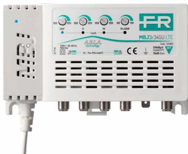
**Amplificateur pour intérieur autoalimenté à 3 entrées (FM+III+DAB, UHF) avec un gain de 32dB et un niveau de sortie jusqu'à 120dB $\mu$ V dans la bande UHF, amplification séparée des bandes, réglage du niveau indépendant (20dB) pour chaque entrée et faible facteur de bruit. Filtre 694MHz 5G et 4G LTE intégré.**
