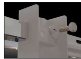
3. Fissaggio barra con braccio verticale tramite vite TE dimensione M8 in acciaio zincato bianco CL.8.8+piastrina di fissaggio M8
