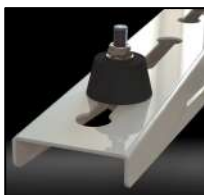
1. Antivibrante in gomma naturale durezza sh 60 con filetto M8
