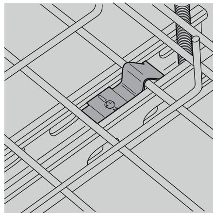
IL SUFFIT D'INSÉRER LE CLIP DE L'ENTRETOISE DANS LE CANAL DU CHEMIN DE CÂBLES, EN VEILLANT À CE QUE L'EXTRÉMITÉ BARBELLÉE SOIT ORIENTÉE VERS LE BAS.
