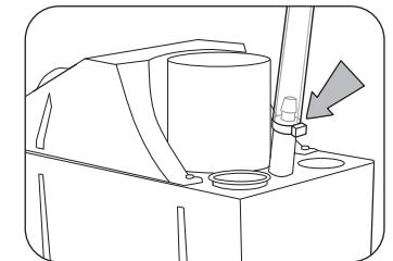
**IMPORTANT:** est impératif de TOUJOURS utiliser le coupe-circuit de sécurité pré cablé.
