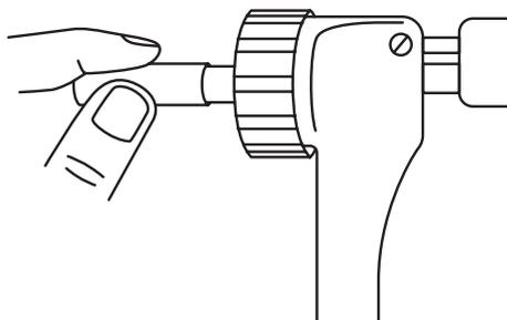
04. Inserire interamente la testina di espansione nel tubo. **Nota:** Se l'imboccatura del tubo è troppo stretta, prima espandere l'estremità del tubo utilizzando la sezione più piccola all'estremità della testina di espansione.
