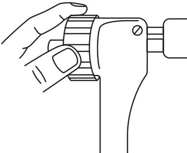
04. Inserte el cabezal de expansión completamente en el tubo. **Nota:** si la abertura del tubo está demasiado apretada, expanda en primer lugar la punta del tubo utilizando la sección más pequeña al final del cabezal de expansión.
