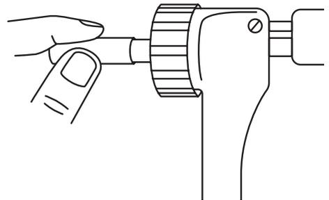
05. Junte las manillas para expandir el tubo. Para obtener un resultado óptimo, expanda el tubo ligeramente y, a continuación, gire el tubo y expándalo de nuevo. **Nota:** esto garantizará que el tubo se expanda por igual en todas las direcciones.
