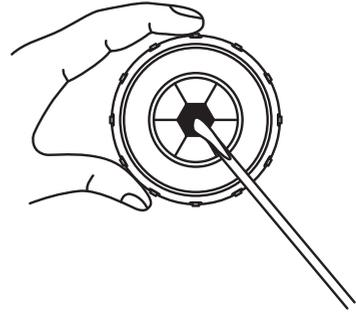
03. Aplique una pequeña cantidad de lubricante al cono del expansor y coloque el cabezal de expansión.
