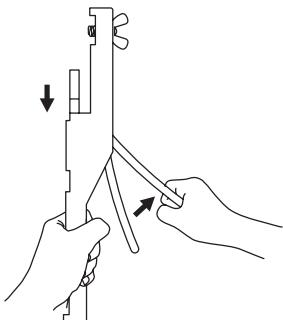
01. Suelte la palanca para permitir que el pistón se deslice hacia el final.
