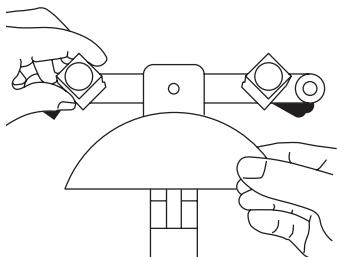
03. Inserte la «corredera» seleccionada en el pistón y gire la pieza deslizante hasta conseguir el tamaño al que deseé doblar el tubo.
