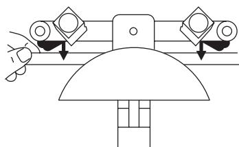
04. Inserire il tubo nel “segmento formante”, premere la leva e lasciare che il “pistone” avanzi iniziando la curvatura
