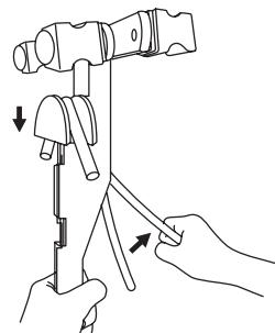
06. Den Hebel nach unten ziehen, um ihn zu lösen, damit sich das „Biegesegment“ zurückzieht, und Rohr herausnehmen.
