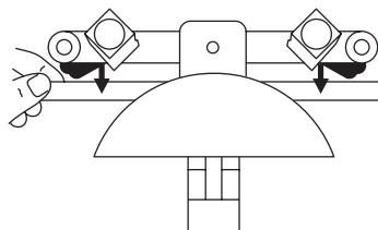
04. Das Rohr in das „Biegesegment“ einführen und den Hebel betätigen, damit sich das „Gestell“ nach vorne bewegt, um mit dem Biegen zu beginnen.
