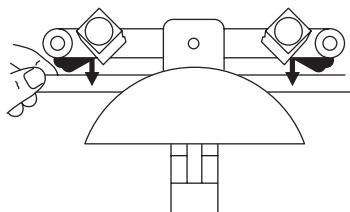
04. Insérer le tube dans le « segment formant », actionnez le levier et laissez le « casier » avancer pour entamer le cintrage.
