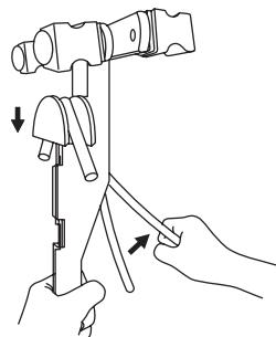
06. Suelte la palanca tirando hacia abajo para retirar la «corredera» y sacar el tubo.
