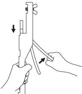
01. Den Hebel lösen, damit das „Gestell“ bis zum Ende gleitet.
