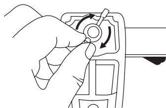
02. Coloque la «barra transversal» en la ranura de la dobladora y ajuste completamente la tuerca tipo mariposa de la parte inferior de la dobladora.
