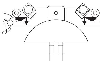
04. Inserte el tubo en la «corredera», pulse la palanca y deje que el pistón avance para comenzar a doblar.
