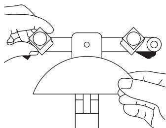
03. Inserire il “segmento formante” scelto nel pistone e girare il pezzo scorrevole fino alla dimensione desiderata per la curvatura del tubo.
