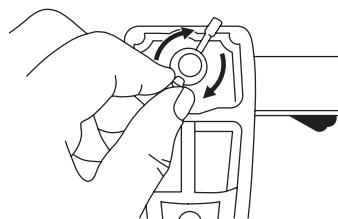
02. Posizionare la “balestra” sulla scanalatura del curvatubi e bloccare il galletto al fondo del curvatubi.
