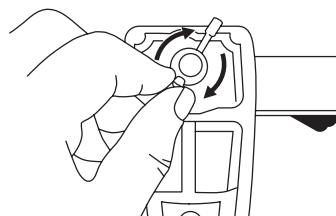
02. Die „Querstange“ auf die Rille des Rohrbiegers setzen und die Flügelmuttern unten am Rohrbieger festziehen.
