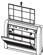
2. Installez le kit du filtre de nettoyage d'air (2).
