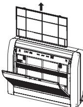
2. Remplacez-les par deux nouveaux filtres de nettoyage d'air.
