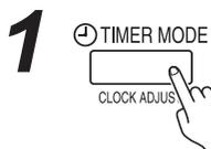
Appuyez sur le bouton TIMER MODE (CLOCK ADJUST) [MODE DE MINUTERIE (RÉGLAGE / HORLOGE)] pendant au moins 2 secondes. L'indicateur de l'heure sur la télécommande clignotera.
