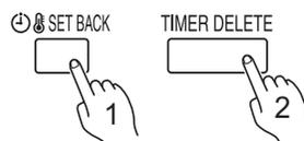
Appuyez sur le bouton SET BACK (RÉTABLIR), puis sur le bouton TIMER DELETE (SUPPRESSION DE LA MINUTERIE) lorsque la confirmation SET BACK (RÉTABLIR) est affichée. Même si le bouton SET BACK (RÉTABLIR) est à nouveau pressé, la minuterie RÉTABLIR sera annulée.
