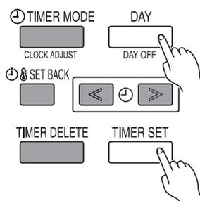
Appuyez simultanément sur les boutons DAY/DAY OFF (JOUR (JOUR D'ARRÊT)) et TIMER SET (RÉGLAGE DE LA MINUTERIE) pendant au moins 2 secondes pour activer la fonction de verrouillage enfant et verrouiller toutes les boutons de la télécommande. Pressez à nouveau les boutons durant 2 secondes ou plus pour désactiver la fonction de verrouillage enfant.
