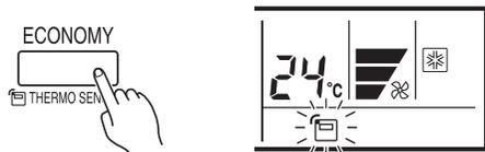
Appuyez sur le bouton ECONOMY (ÉCONOMIE) pendant au moins 2 secondes afin de sélectionner si la température de la pièce est détectée au niveau de l'appareil intérieur ou de la télécommande.
