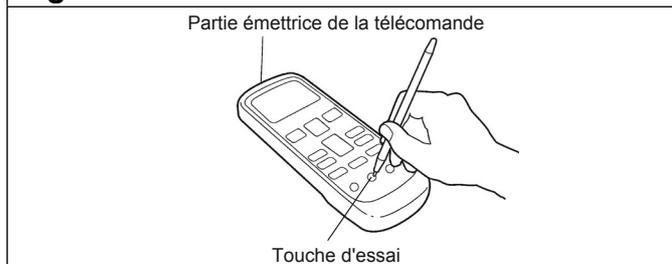
• Pour terminer l'essai, appuyez sur le bouton "START/STOP". (Lorsque le climatiseur est mis en marche avec la touche "TEST", les témoins "OPERATION" et "TIMER" clignotent simultanément lentement. Lors du démarrage les clignotements s'arrêtent.)
