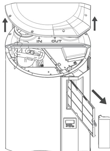
Si nécessaire, l'évaporateur sera nettoyé à l'aide d'un pinceau à poils souples. Le broyage de l'évaporateur doit être délicat pour ne pas endommager les ailettes de l'évaporateur. Dans le cas où les ailettes seraient pliées, les redresser à l'aide d'un peigne adapté.
