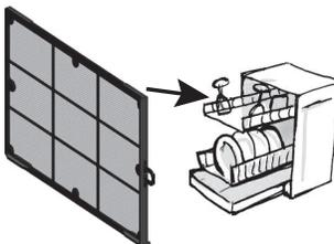
► Nettoyer le filtre à l'eau savonneuse, sans endommager le film filtrant. Le filtre est compatible avec un nettoyage au lave-vaisselle.
