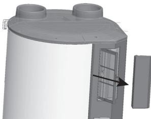
► Tirer sur la trappe à filtre puis sur le filtre pour le retirer de son logement. Fermer la trappe à filtre.
