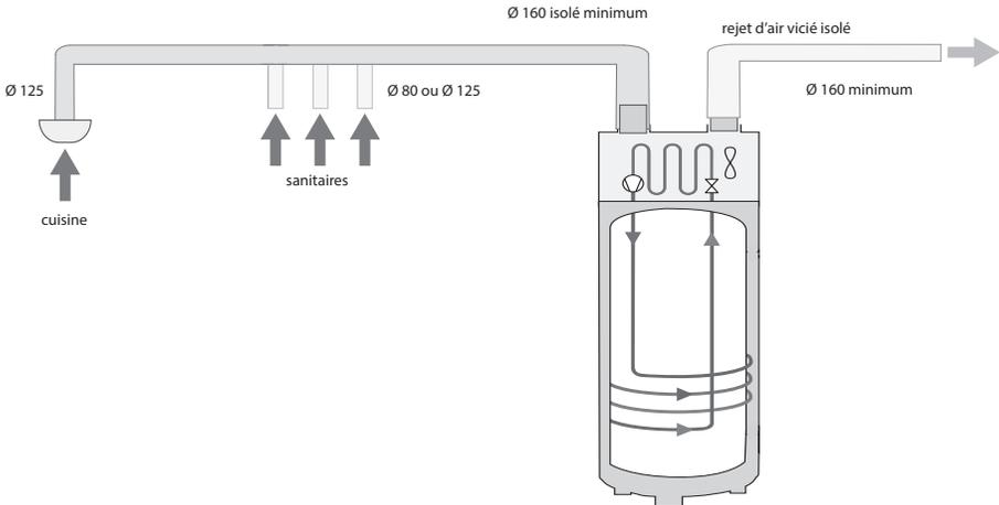
Les calories de l'air chauffé extrait du logement sont utilisées pour la production d'eau chaude.
