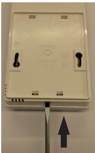
Appuyer sur le bouton pour déverrouiller les loquets du boîtier
