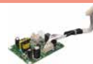
Platine interface pour le raccordement des télécommandes filaire / filaire simplifiée UTY-TWBXF2-2
