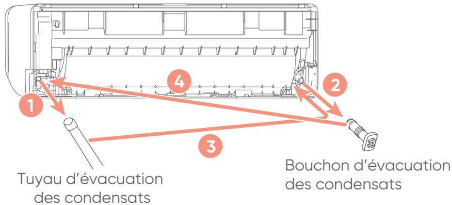
1. Déposer le tuyau d'évacuation des condensats.
