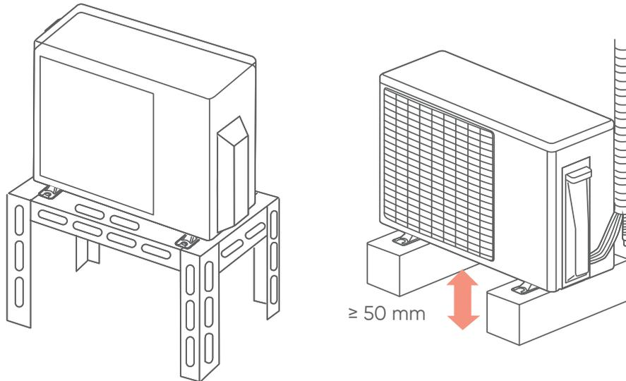
1. Installer l'unité horizontalement (ne pas l'incliner de plus de 3 degrés). S'assurer lors de la pose des fondations d'avoir suffisamment d'espace pour installer les raccordements frigorifiques.
