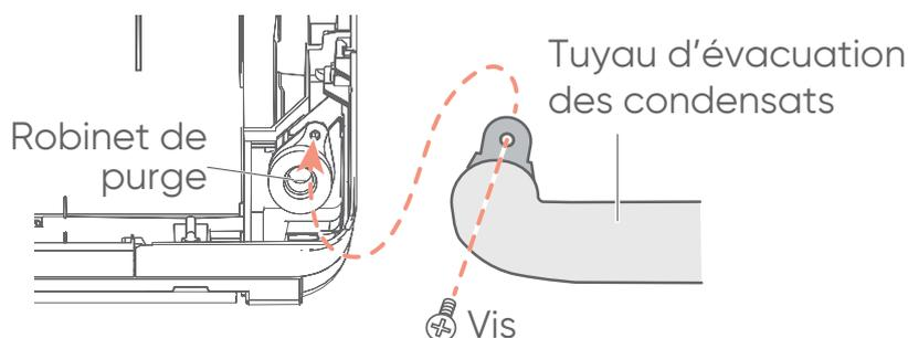
4. Utiliser une clé Allen hexagonale 4 mm pour insérer le bouchon jusqu'à ce qu'il soit en contact avec le robinet de purge.
