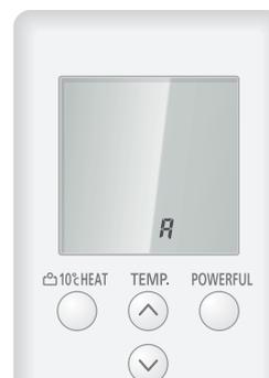
3. Appuyer sur les boutons pour changer le code **A** ↔ **b** ↔ **c** ↔ **d**. Le code sur l'affichage doit correspondre au code du climatiseur.
