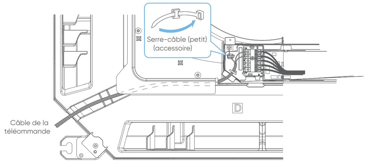
5. Replacer le couvercle électrique et le cache du câblage. Serrer fermement les vis
