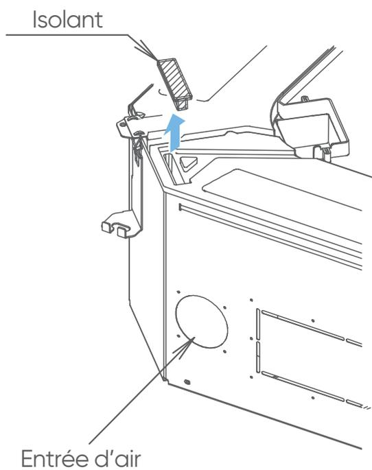
Lorsque l'entrée d'air neuf est utilisée, retirer l'isolant de l'évacuation des condensats.
