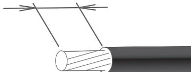
2. Avec une pince à sertir, poser en bout de fil une cosse ronde à sertir du diamètre correspondant aux vis du bornier.
