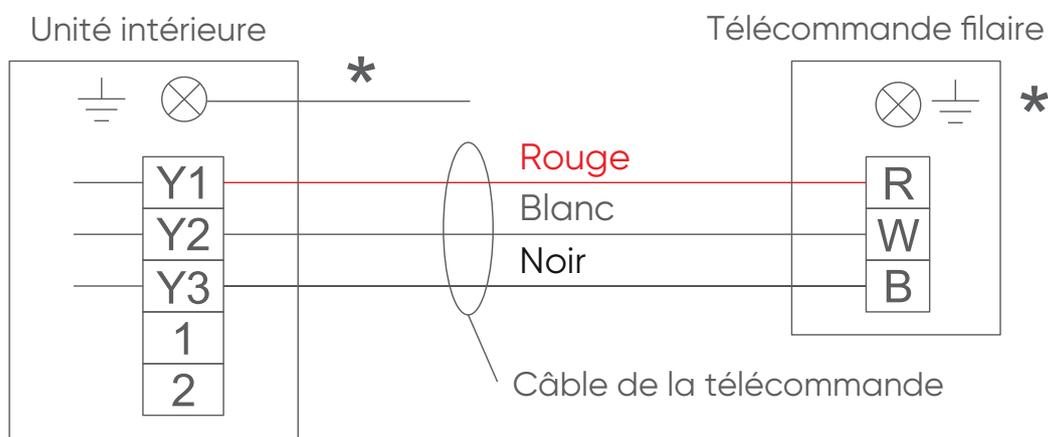
\* Raccorder à la terre la télécommande si elle dispose d'une ligne de terre (masse).
