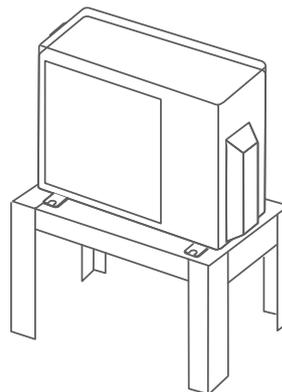
1. Installer l'unité horizontalement (ne pas l'incliner de plus de 3 degrés). S'assurer lors de la pose des fondations d'avoir suffisamment d'espace pour installer les raccordements frigorifiques.
