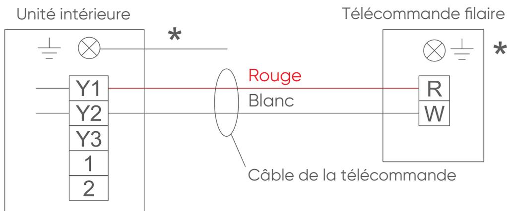
\* Raccorder à la terre la télécommande si elle dispose d'une ligne de terre (masse).
