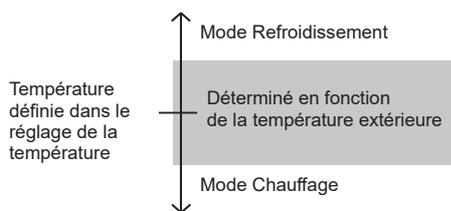
Lorsque le mode Auto est sélectionné pour la première fois, le ventilateur fonctionnera à faible vitesse pendant quelques minutes, jusqu'à ce que l'unité intérieure détecte les conditions ambiantes et sélectionne le mode de fonctionnement.
