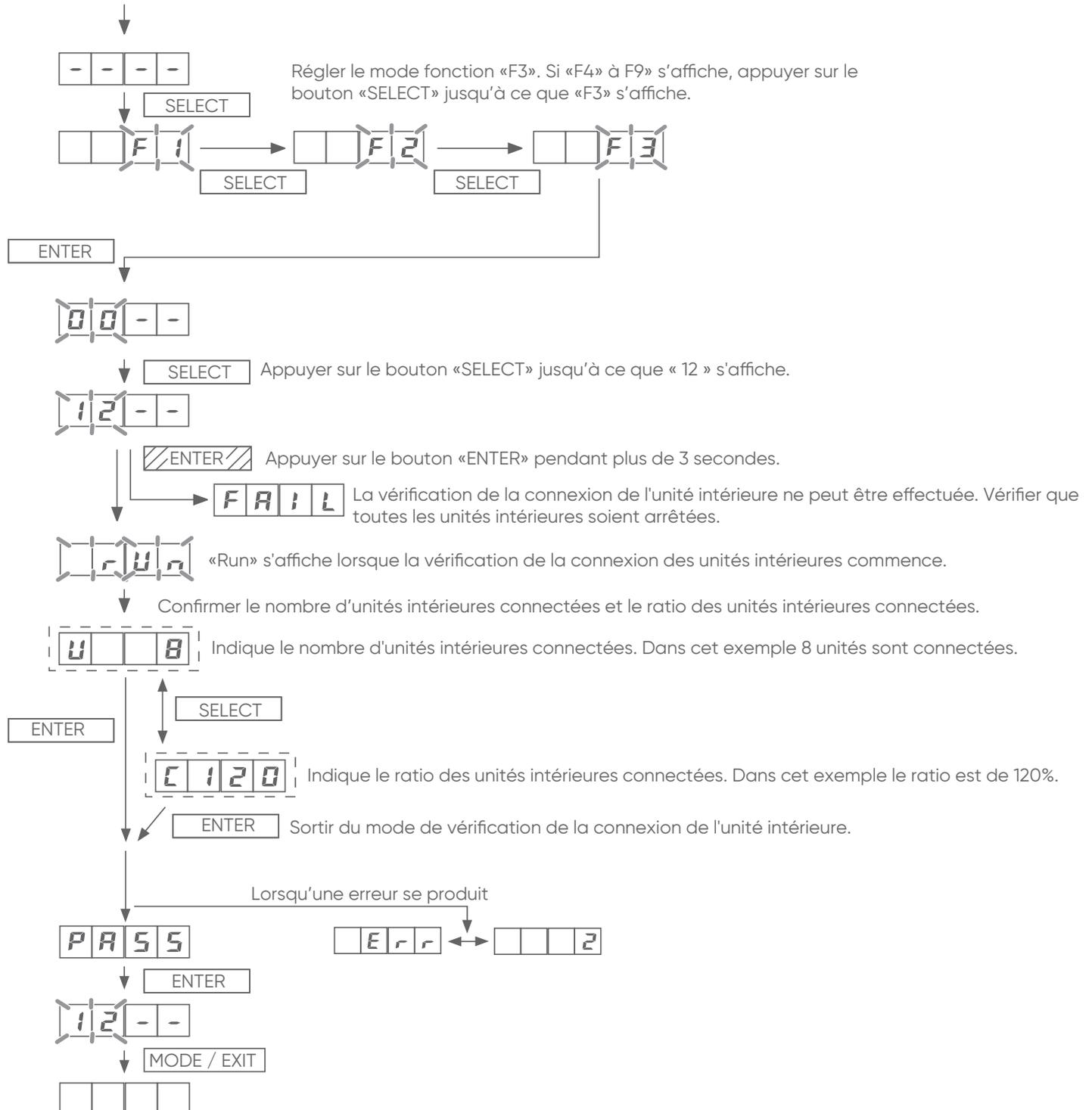
Lorsque la procédure se termine normalement, rien ne s'affiche sur les LEDs.
