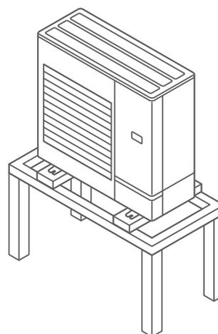
1. Installer l'unité horizontalement (ne pas l'incliner de plus de 0,3 degrés). S'assurer lors de la pose des fondations d'avoir suffisamment d'espace pour installer les raccords frigorifiques.
