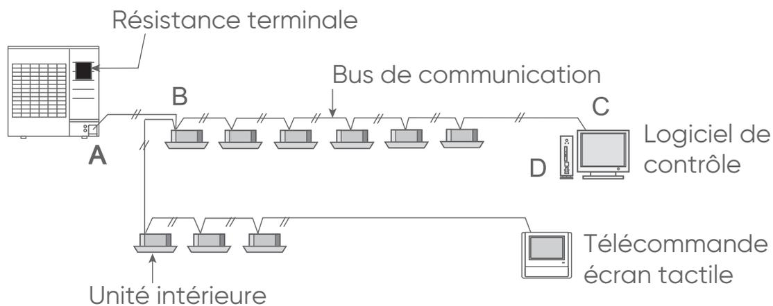
Lorsque  $AB + BC + BD > 500 \text{ m}$ , un amplificateur de signal est nécessaire.
