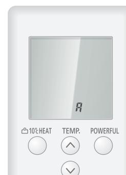
3. Appuyer sur les boutons <sup>TEMP.</sup> pour changer le code **A** ↔ **b** ↔ **c** ↔ **d**. Le code sur l'affichage doit correspondre au code du climatiseur.
