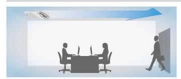
**Débit d'air horizontal :** ne souffle pas l'air froid directement sur les occupants de la pièce.
