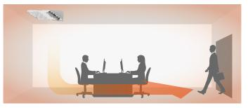
**Débit d'air vertical :** fournit un chauffage performant dans le volume traité.
