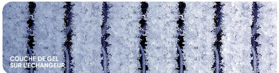
Cette fonction génère dans un premier temps une couche de givre sur l'échangeur de l'unité intérieure et extérieure, permettant de **décrocher et d'emprisonner rapidement la saleté de la surface**. Puis, ce même échangeur est ensuite chauffé pour éliminer ce givre et **éviter ainsi la croissance de bactéries**.
