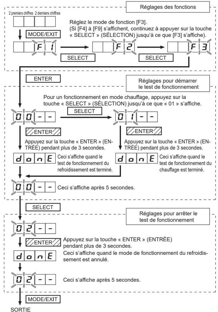
Une fois le test de fonctionnement terminé, coupez l'alimentation électrique. Fixez le couvercle du boîtier électrique et le panneau avant de l'unité extérieure.
