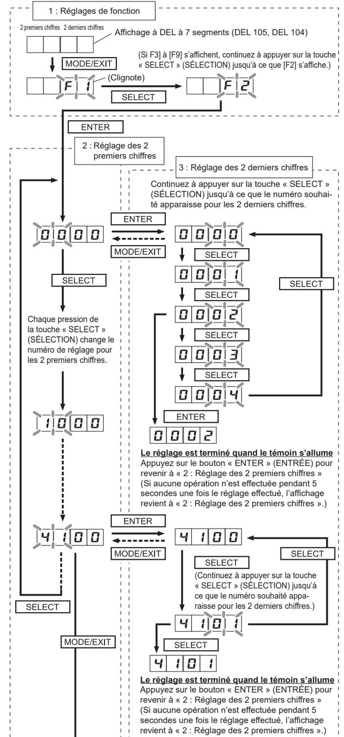
SORTIE : Appuyez sur la touche « MODE/EXIT » (MODE/SORTIE) pour annuler le mode de réglage.
