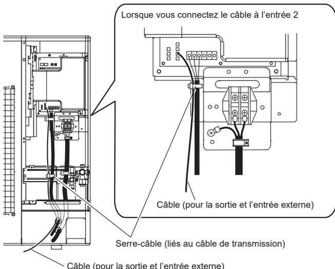
\* Si l'unité extérieure n'est pas installée dans le mur, couvrez la partie exposée d'un câble avec tube d'isolant d'1 mm d'épaisseur ou plus.
