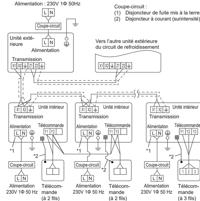
\*1: Le nombre de bornes d'alimentation est différent en fonction du modèle d'unité intérieure. Pour le câblage, consultez le manuel d'installation de l'unité intérieure.
