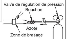
Si vous n'utilisez pas d'azote pour brasier un tuyau, un film d'oxydation se formera. Ce film peut altérer les performances de l'unité ou endommager ses pièces (telles que le compresseur ou les valves).
