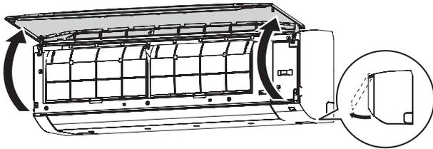
3. Ouvrez le capot de l'adaptateur WLAN jusqu'à ce qu'il s'enclenche.
