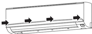
**REMARQUE :** Si de la saleté s'accumule sur le filtre à air, cela réduit le flux d'air, l'efficacité de fonctionnement diminue et le bruit augmente.
