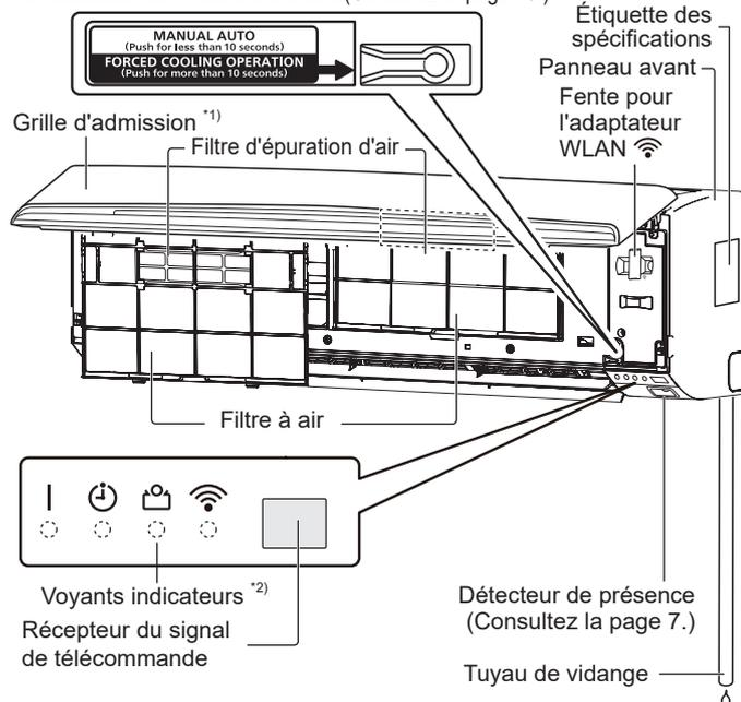
\*1) Avant de démarrer l'appareil, vérifiez que la grille d'admission est complètement fermée. Une fermeture incomplète risque d'affecter le bon fonctionnement ou les performances de l'appareil.
