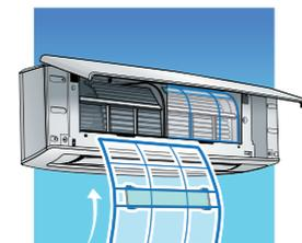
Remettre le pré-filtre en place et recommencer l'opération avec le second filtre
