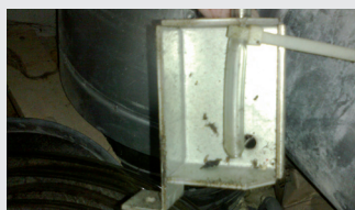
Les extrémités des capillaires en fond de colonne ne sont pas encrassées et le fonctionnement est toujours aussi performant.
