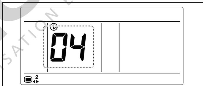
2. La température détectée par le capteur de température de l'unité s'affiche.
