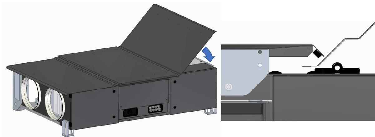
Etape 3 : Une fois les panneaux à l'horizontal et les joints correctement écrasés, fixer les vis latérales
