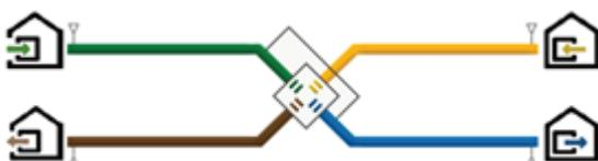
Échangeur à plaques à contre-courant
