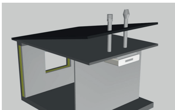
Configuration 1 avec aspiration et rejet en toiture
