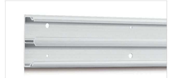
Le socle dispose de pré-poinçonnages et d'une cloison guide clous pour une fixation aisée. Le socle comporte deux nervures latérales avec fonction butée de pose.
