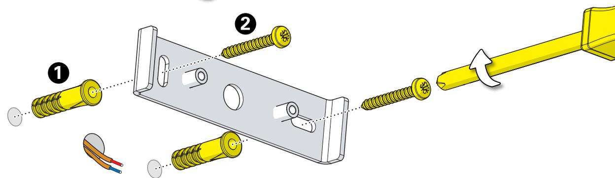
**6** Fixation du support appareillage
